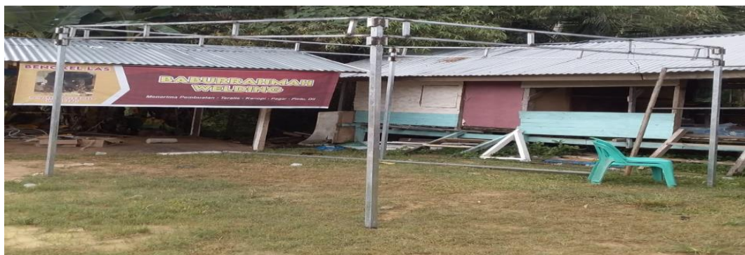
Gambar 4.9 Rangka Tenda Hasil Pelatihan Pengelasan
